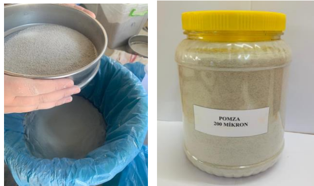
Görsel 11. Pomzanın 200 mikronluk elekten geçirilme aşaması. (Bayter,2023)
