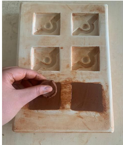
Görsel 13. Pomza katkı çamurun deney plakalarına basılması. (Bayter, 2023)
