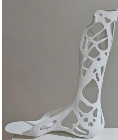
Şekil 6. Optimize edilmiş ayak-ayak bileği ortezinin SLS teknolojisi ile üretilmiş 3B baskı modeli.
