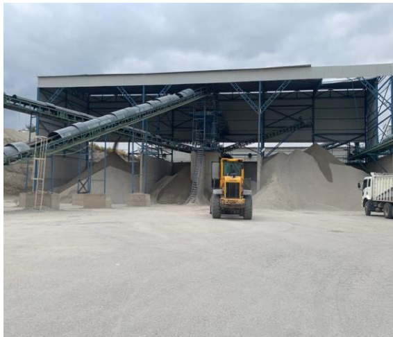
Görsel 4. Pomza Fabrikasının Kırma işleminden sonra toz haline getirilen pomzanın bantlar yardımıyla taşınan stok alanı.
