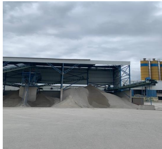
Görsel 4. Pomza Fabrikasının Kırma işleminden sonra toz haline getirilen pomzanın bantlar yardımıyla taşınan stok alanı.
