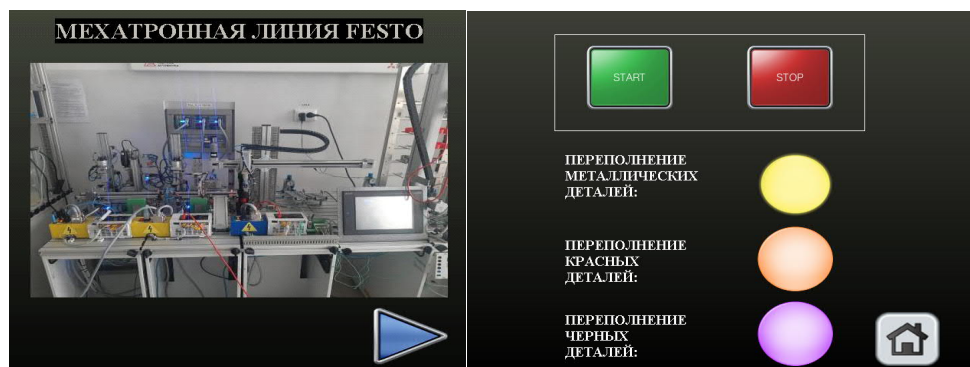
Рисунок 4. Панель оператора, которая должна получиться в результате лабораторной работы №4
