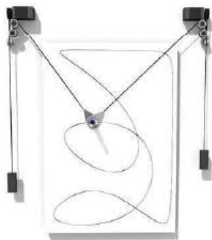
Рисунок 1: Концепция V-плоттера. Рисунок 2: Использование закона Пифагора для расчета длины «веревки».
